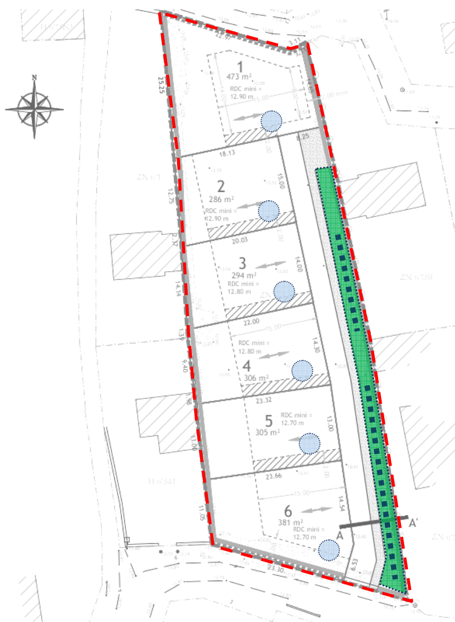
Schéma de principe de gestion des eaux pluviales
